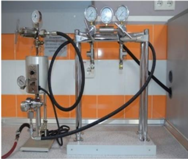
Рис.10. 2. – Прилад фільтр-пресс OFITE в умовах високого тиску
