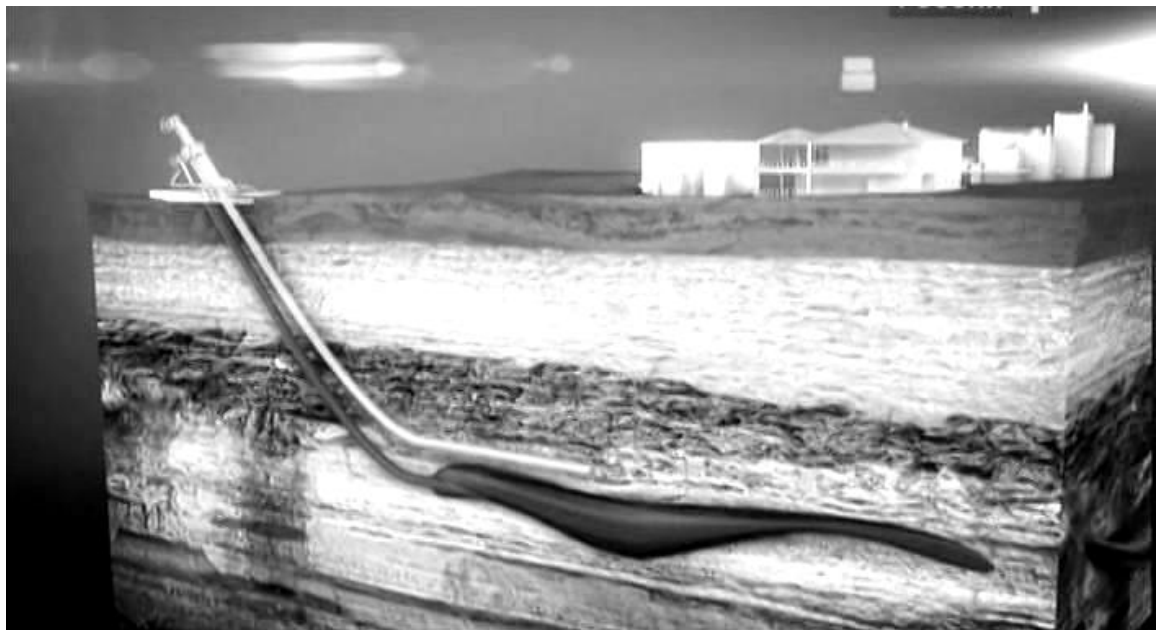
Рис. 7. Схема технології видобутку важкої нафти похило-скерованими свердловинами під кутом 45° (Татарстан)
