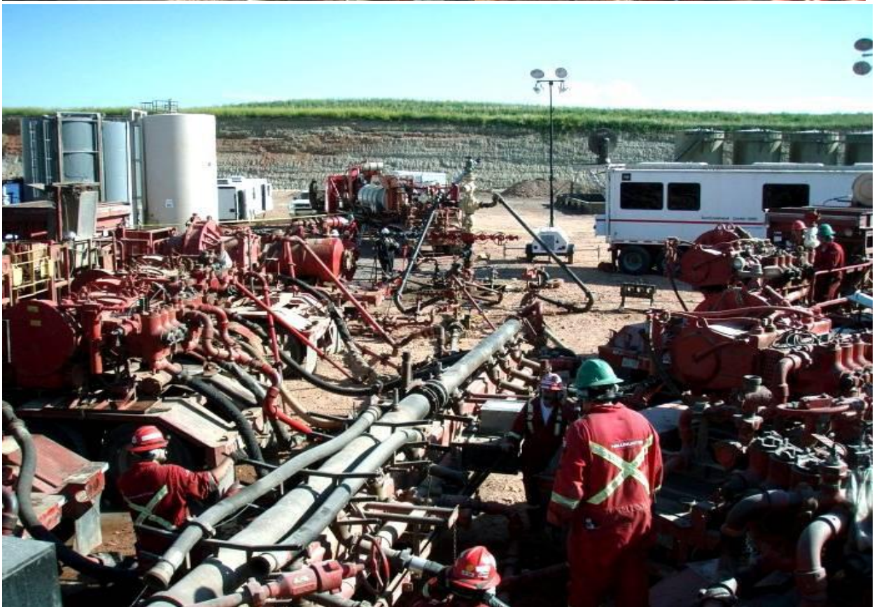
Рис. 15 – Поверхнєве обладнання для гідророзриву пласта (родовище Баккен, Пінічна Дакота, США)
