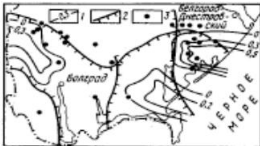
Рисунок 3. Поширення вугленосної моласи у Переддобрузькому прогині: 1 - ізопахіти верхньовізе-серпуховського ярусу; 2-розломи; 3 — свердловини і товщини нижньої моласи
